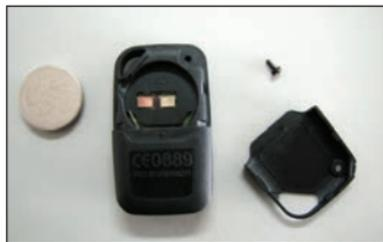
Ôtez la petite vis de fixation. En insérant un tournevis plat dans l'encoche sous la vis (voir schéma), faites doucement levier pour ouvrir le boîtier.
